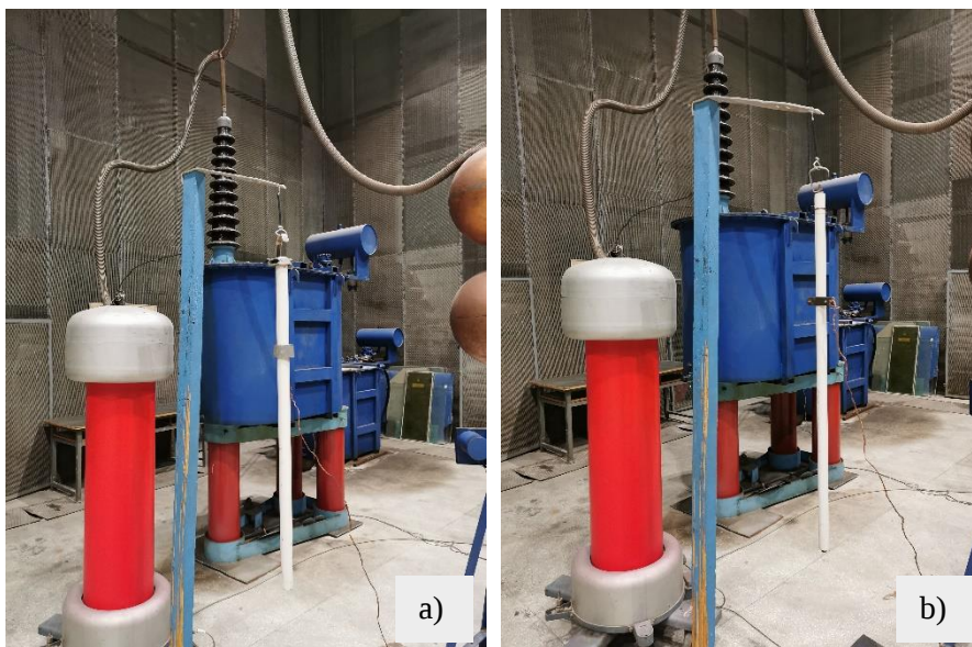
Fig. 3 – Modele de laborator ale izolatoarelor tip suport - a), respectiv de trecere - b)
